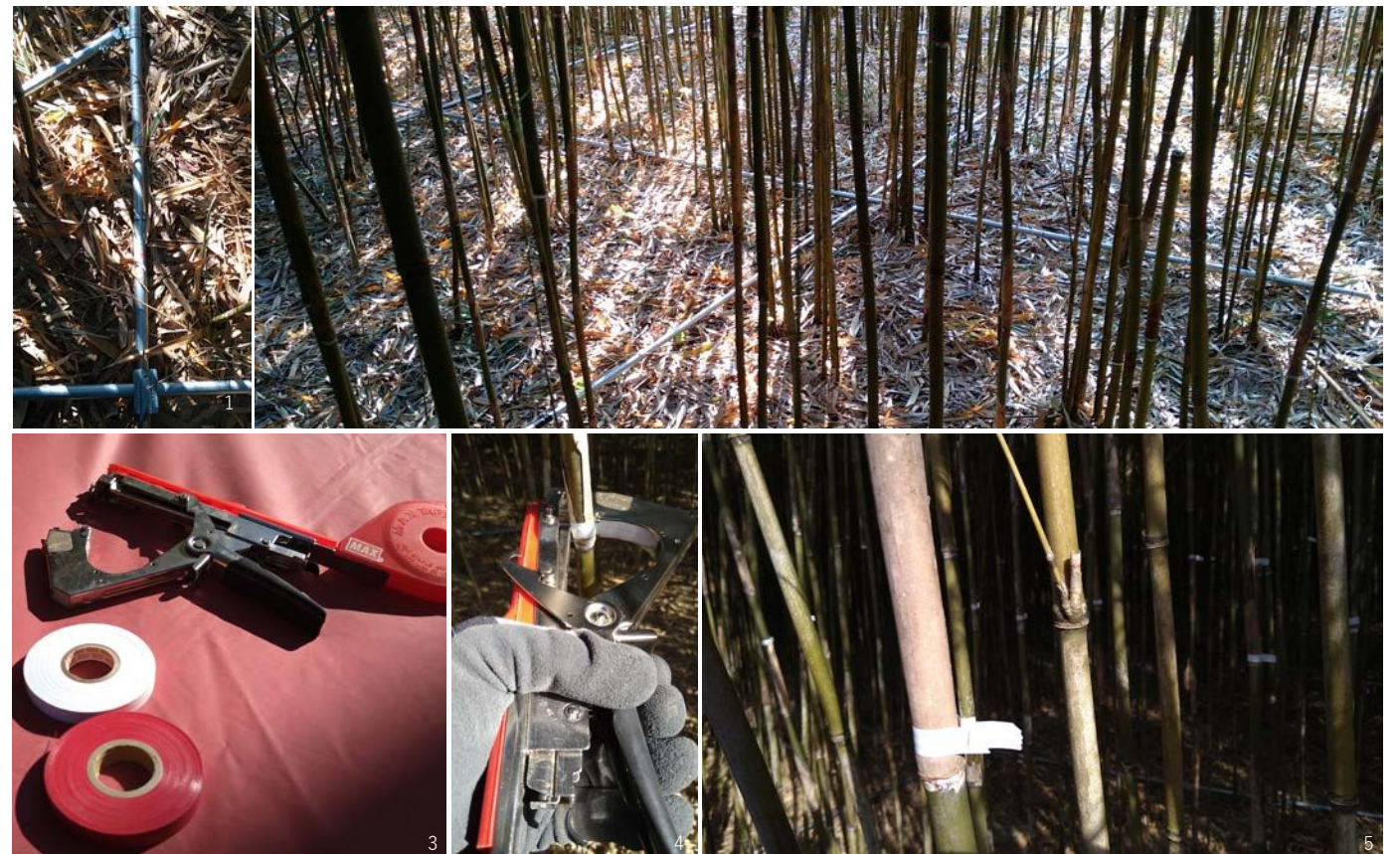
1 女竹の実験林を区画するための単管パイプ 2 区画内のエリア 4 つ（エリア別評価用） 3～5 女竹を特徴別に分類評価するためのおテープナー結束機とテープがつけられた実験区
