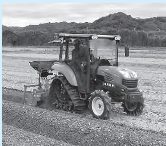
耕運・畝たて作業中のトラクター
