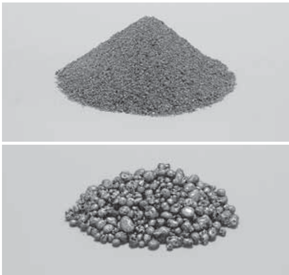
シャフト炉で排出される熔融スラグ(上)とメタル(下)
