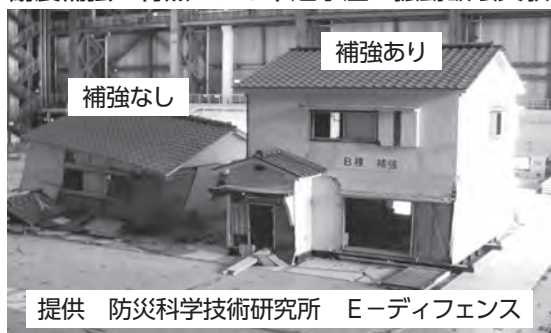
耐震補強の有無による木造家屋の振動破壊実験
