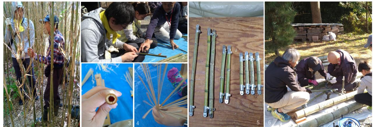
1,2「房州うちわ従事者入門講座」の第1回講座女竹の選定・伐採・皮むきの様子。3,4第2回講座の割竹(48～64等分)の作業風景。女竹の質によって作業性が大きく左右される。5.「南房総市竹あかり」イベント設置での「組み立てる負担」半減を目指した竹灯籠同志をつなぐ新固定システム(構成する9本の竹部材) 6.実際の設置現場で組み立てやすさを検証。
