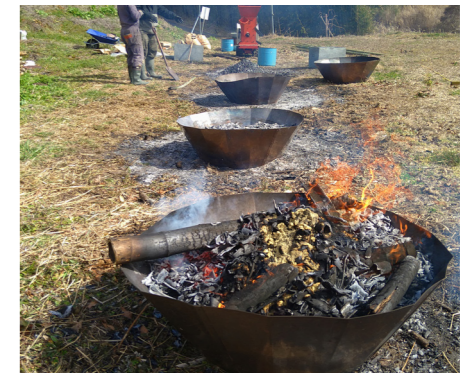
12 簡易的な竹炭・竹灰製造法の検証 上：竹パウダーを竹炭竹灰にする試み、 下：竹だけを炭にした奥のトレイに比べて燃え残りあり
