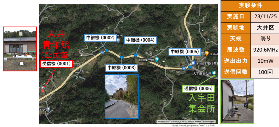
図-6 LPWA を利用した安否情報共有ネットワークにおける通信の中継実験
