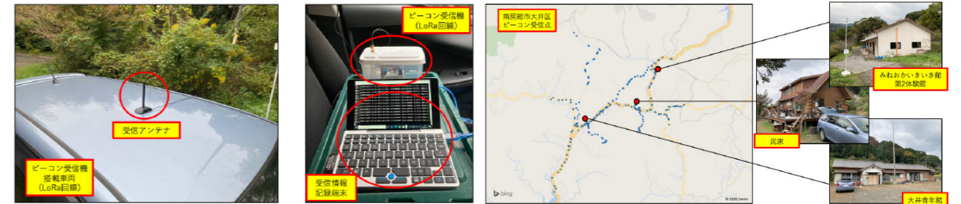
図1 計測車に設置したLoRaビーコン受信機
