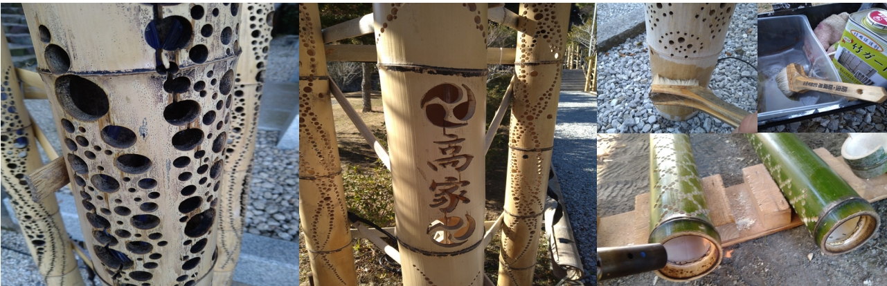
4 「南房総竹あかり」イベントの運営・管理の効率化（左：切り口を中心に発生する黒カビ、中：防カビ材の塗布後3ヶ月の状況 右：防虫防カビ対策の様子）
