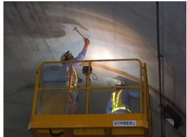
写真 3.2 近接目視点検・打音調査
