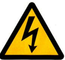
感電注意 Caution, electricity [注1] 文字による補助表示が必要 理解度 79.7
